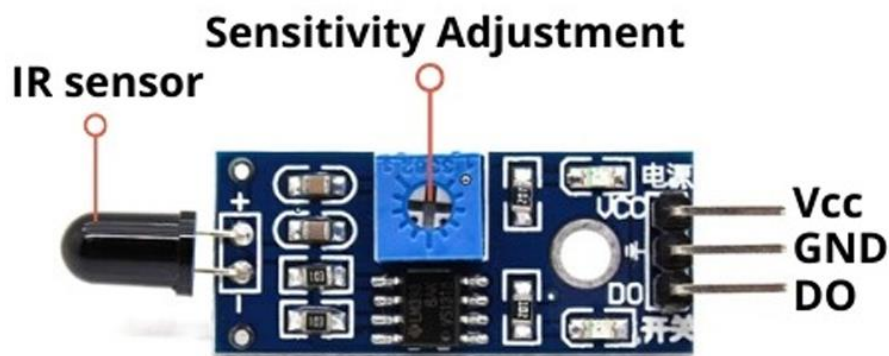
Fig 3.1.3 Ir Flame Sensor Module
